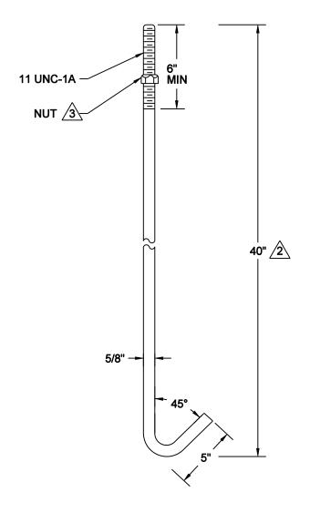
MATL-STEEL, ASTM, A36 (5/8" DIA x 45" LONG BEFORE BEND)
